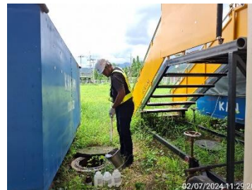
บ่อพักน้ำหลังผ่านระบบบำบัดน้ำเสียสำเร็จรูปของอาคารผู้โดยสารขาเข้า จุดที่ 2
