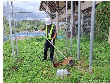
บ่อพักน้ำหลังผ่านระบบบำบัดน้ำเสียสำเร็จรูปของอาคารผู้โดยสารขาเข้า จุดที่ 1
